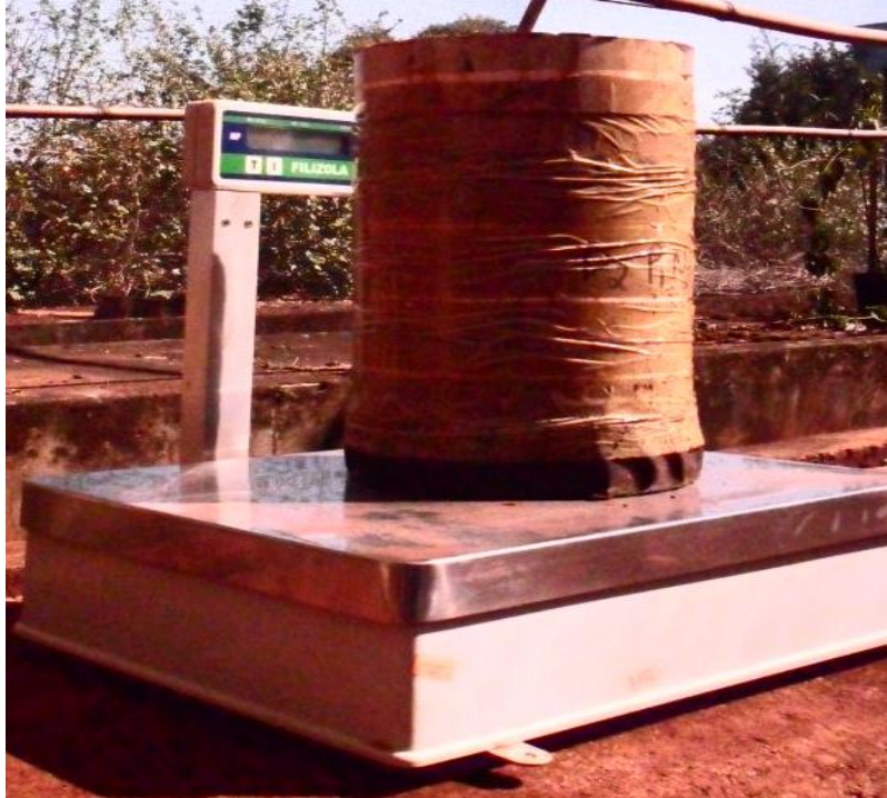
Figura 3. Pesagem das colunas de solos, para realização da irrigação. Dourados-MS, 2010.
