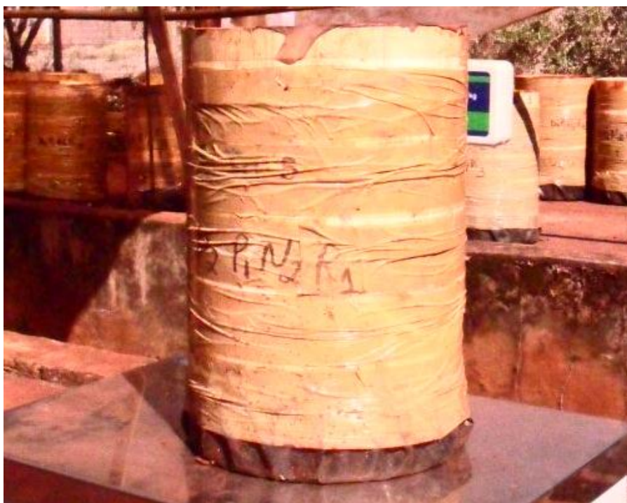
Figura 1. Colunas de solos, de PVC de 200 mm unidos por fita adesiva, e lona plástica para fechar o fundo da coluna UFGD, Dourados-MS, 2011.
