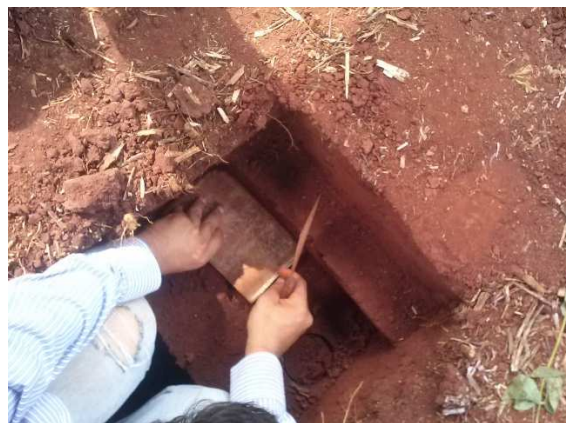
APÊNDICE 8. Raspagem na lateral da trincheira (0,00-0,10 m) para química do solo, 24/11/2014. Foto: arquivo pessoal.
