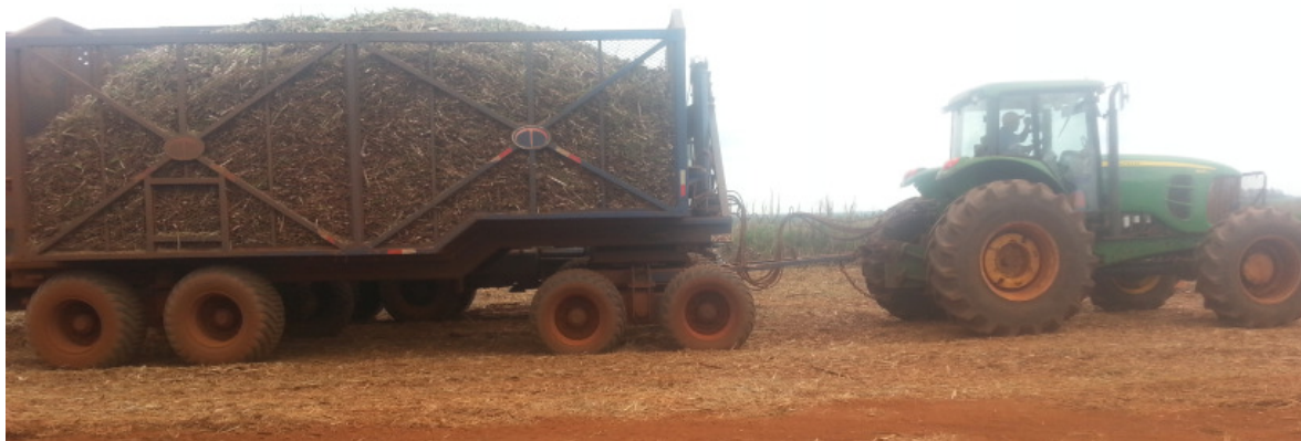
Figura 3. Transbordo com capacidade para carregar até 22 Mg de cana-de-açúcar, com massa média de 12,5 Mg distribuídos em oito pneus de alta flutuação, sendo quatro pneus dianteiros modelo 550/45-22,5 com pressão de inflação de 0,29 MPa e os quatro pneus traseiros modelo 600/50-22,5 com pressão de inflação de 0,38 MPa com massa total do conjunto carregado de 43 Mg.
