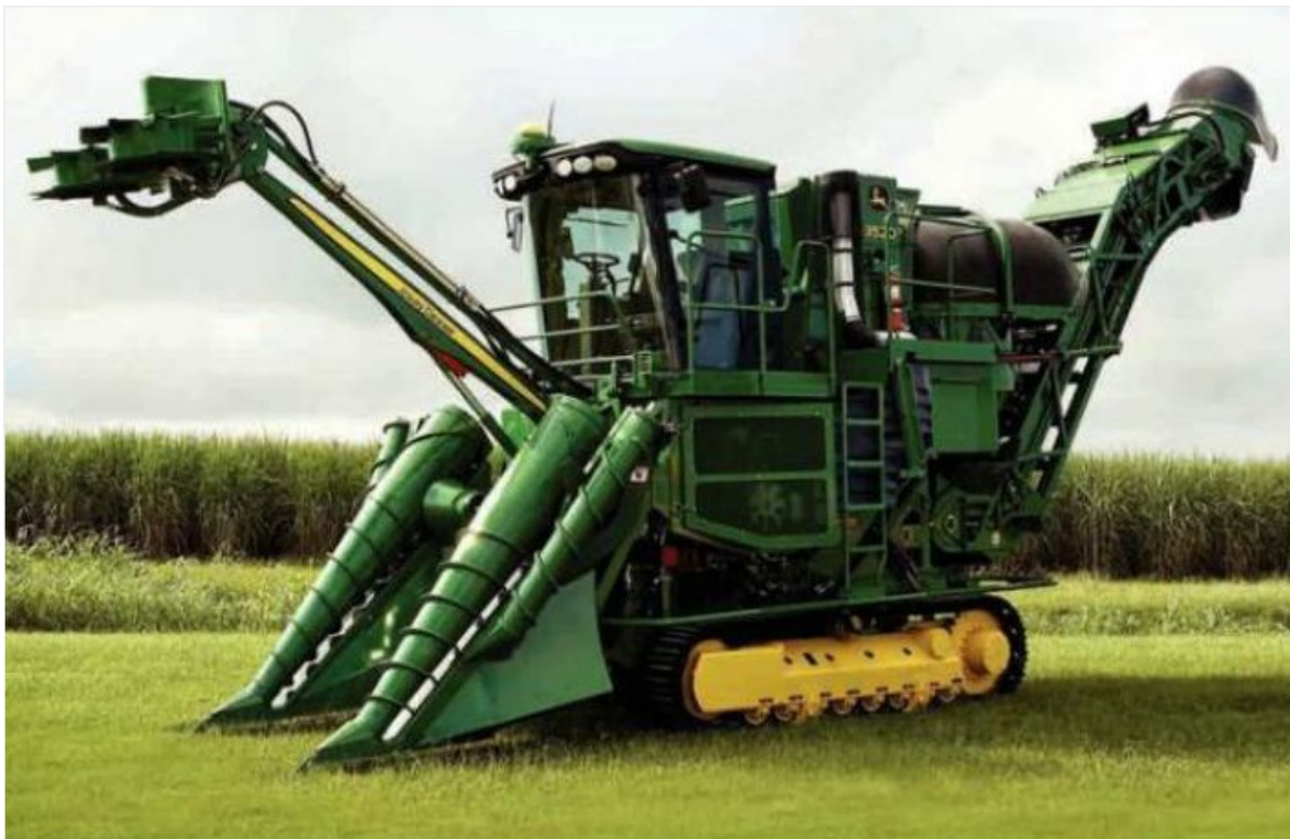
Figura 1. Colhedora 3520, com 335cv de potência bruta e 17 Mg de massa,
