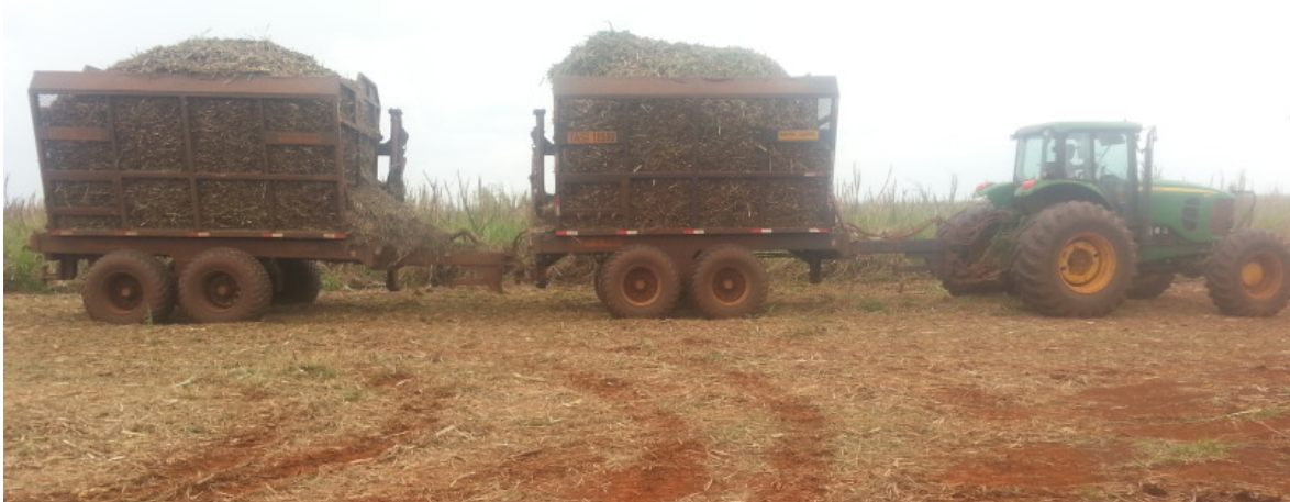
Figura 2. Transbordos, com massa de 8,0 Mg cada compartimento, distribuídos em quatro pneus de alta flutuação modelo 600/50-22,5 com pressão de inflação de 0,38 MPa, com capacidade para carregar até 10Mg em cada compartimento com massa total do conjunto carregado de 46 Mg.
