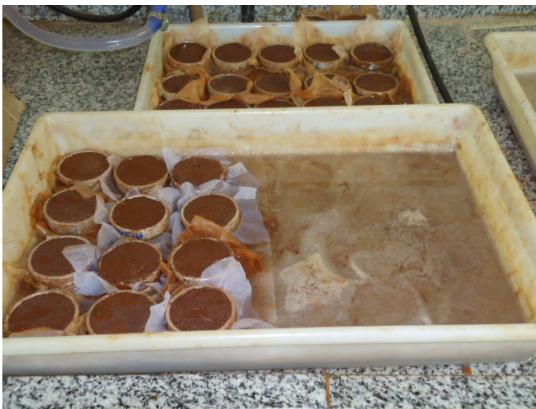
Figura 5. Saturação das amostras por elevação gradual da lâmina de água.
