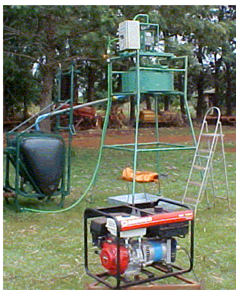
Figura 2. Vista geral do infiltrômetro de aspersão-InfiAsper (Alves Sobrinho, 2002b).
