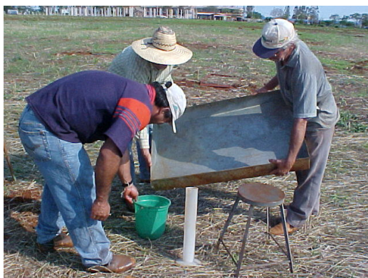
Figura 8. Verificação da intensidade de precipitação.
