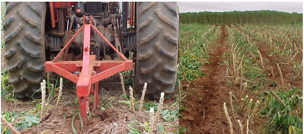
FIGURA 2. Afofador de mandioca em operação e área trabalhada, pronta para a retirada das raízes.
