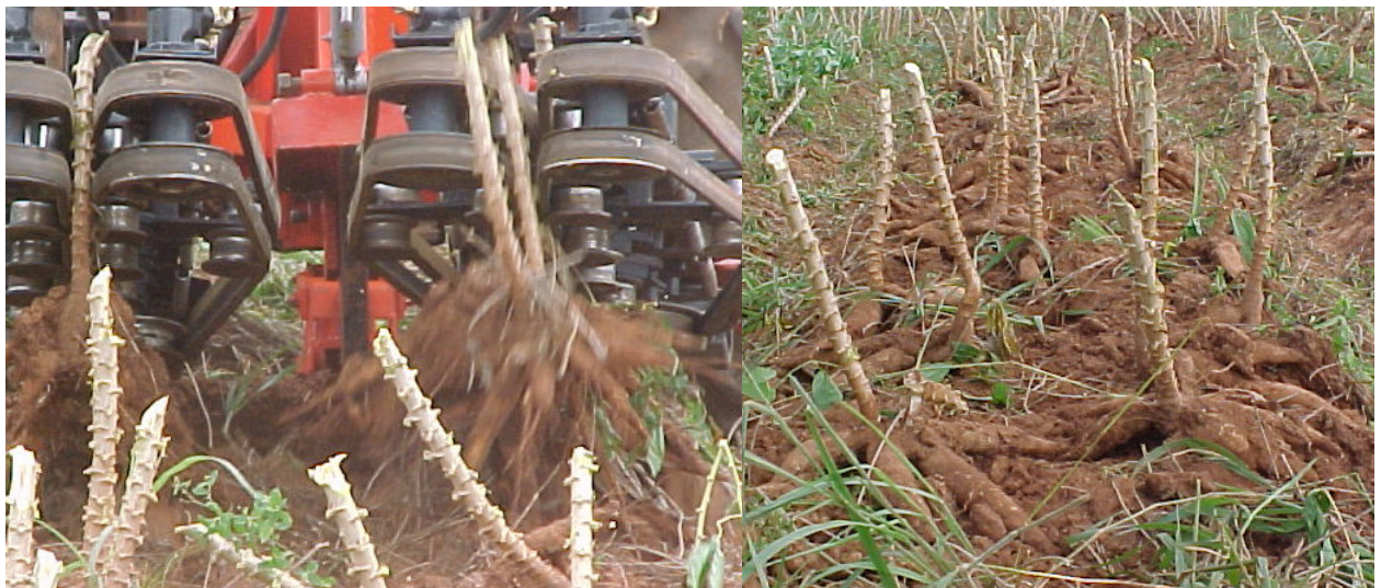
FIGURA 4. Arrancador de mandioca em operação e área trabalhada, pronta para a retirada das raízes.
