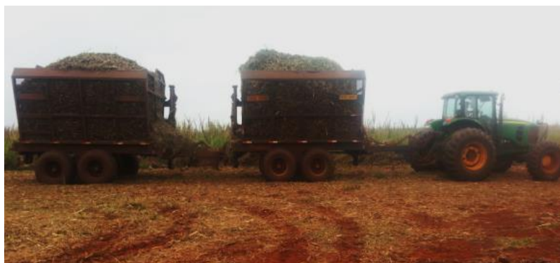
Figura 4. Transbordos, com massa de 8,0 Mg cada compartimento, distribuídos em quatro pneus de alta flutuação modelo 600/50-22,5 com pressão de inflação de 0,38 MPa, com capacidade para carregar até 10 Mg em cada compartimento com massa total do conjunto carregado de 46 Mg.
