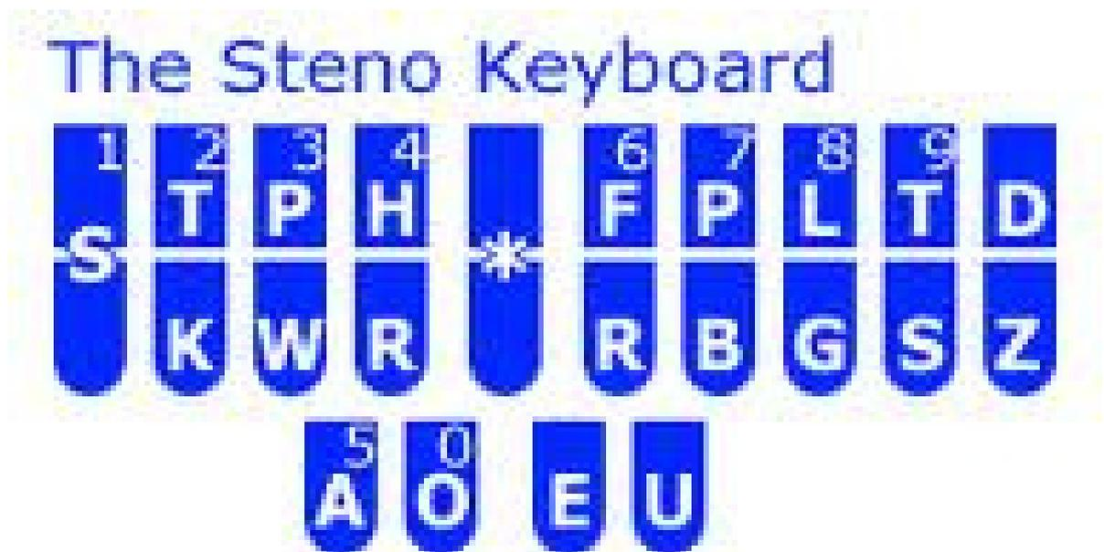
Figura 2 - Configuração do teclado do estenógrafo, cujos botões são baseados em fonemas em vez de letras, o que aumenta a velocidade de digitação por um profissional treinado.
