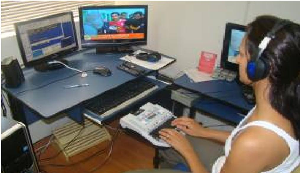
Figura 3 – Estenotipista em atuação, seu trabalho consiste em ouvir as palavras que estão sendo ditas, traduzi-las para os códigos que aprendeu durante o curso e estenotipá-las na máquina. O estenótipo fica acoplado a um computador que auxilia, através de um *software*, na tradução das notas estenotipadas o que permite a tradução simultânea do registro da fala para o escrito.
