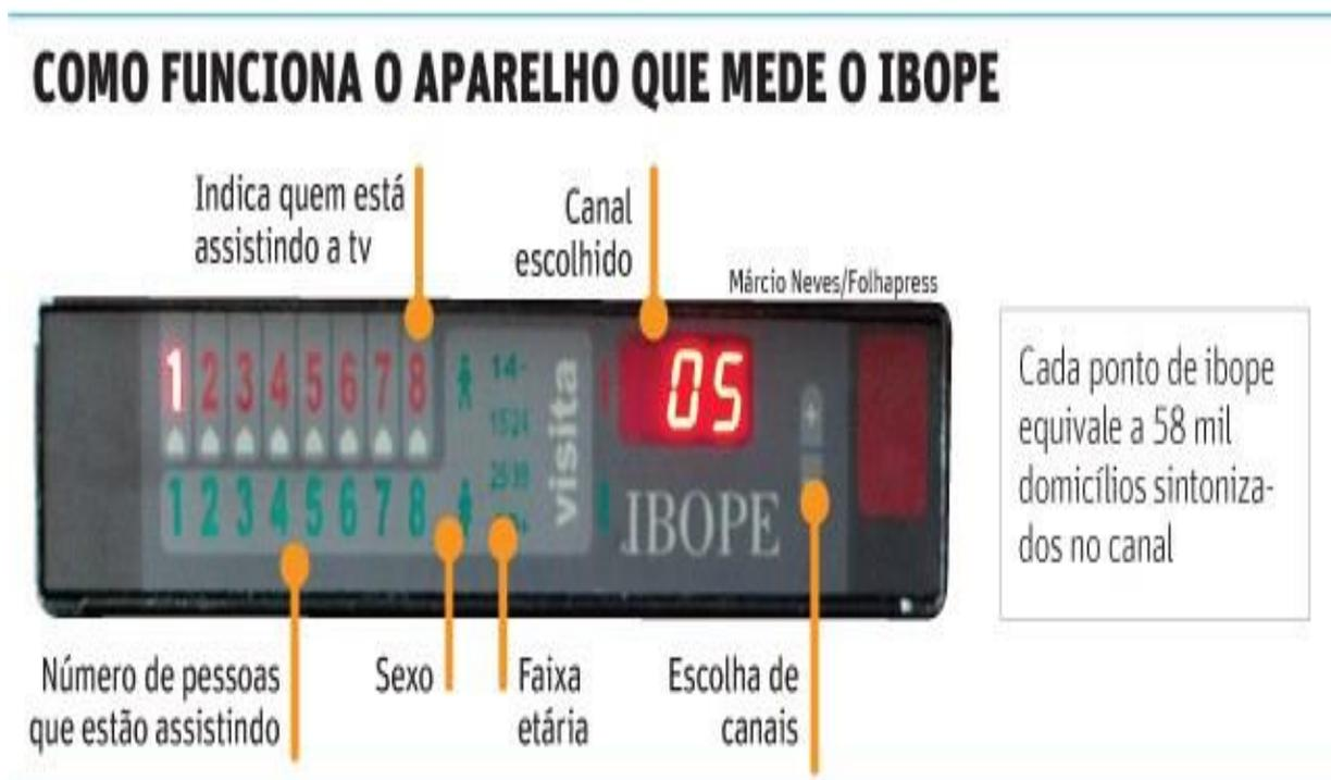
Figura 06 - DIP. Ilustração do aparelho utilizado para registrar ibope
