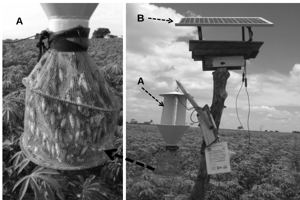
Figura 01. Armadilha luminosa Modelo Luiz de Queiroz - A; Paineis fotovoltaicos para carregar a bateria - B; instalada na cultura da mandioca para monitoramento de adultos de Erinnyis ello (Lepidoptera: Sphingidae).
