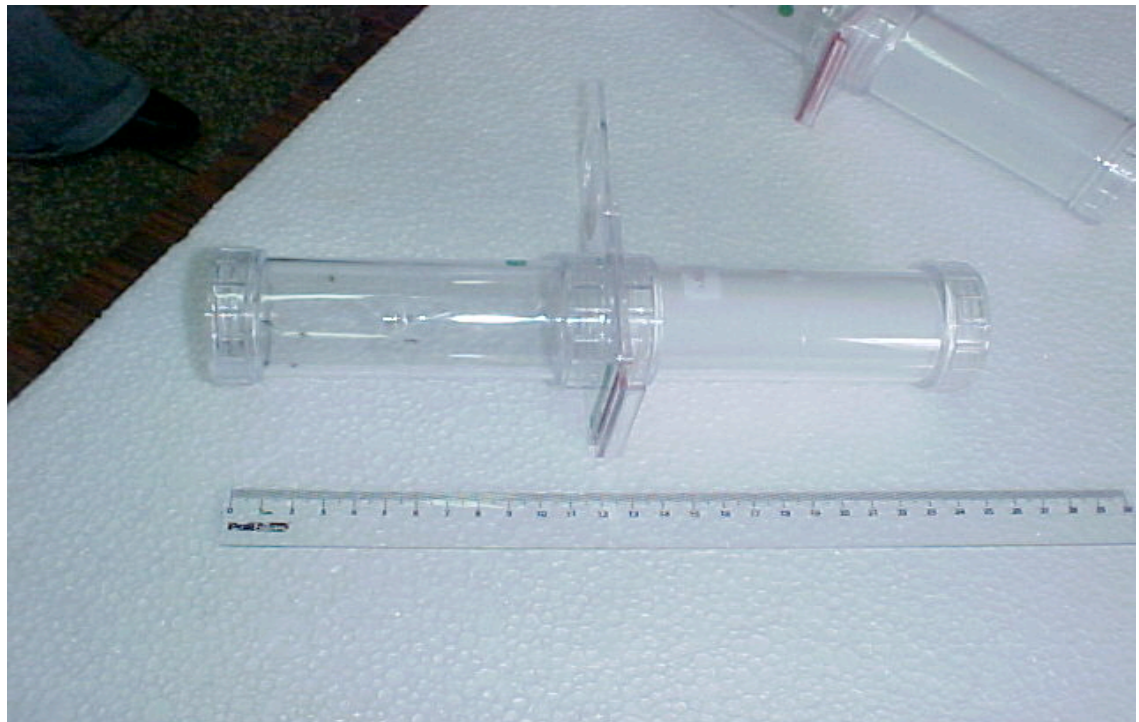
Figura 10. Tubos OMS de plásticos padronizados (kits) para avaliação de susceptibilidade a inseticidas.
