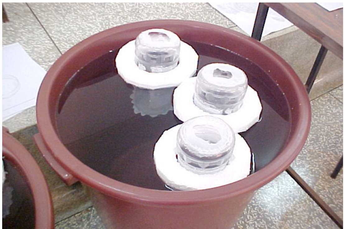
Figura 9. Recipientes de plástico transparente com duas faces laterais abertas e as faces inferiores e superiores vedadas com organza branco. Foi utilizado isopor para manter os recipientes flutuando, em tambores de plástico de 100 litros.
