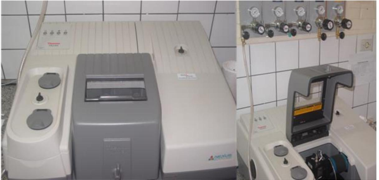
**Figura 1.** Espectrofotômetro infravermelho utilizado na análise de HC por FTIR-PAS.
