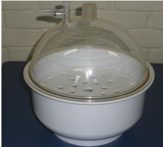
**Figura 5.** Estufa à vácuo utilizada para retirar a umidade dos gásteres antes das análises de HC por FTIR-PAS.
