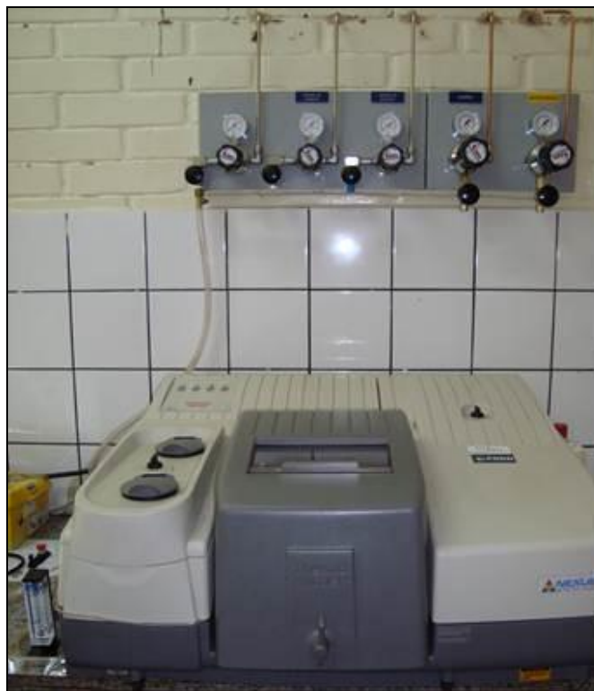
Figura 1. Espectrofotômetro com Transformada de Fourier utilizado para análise do veneno. Fonte: Mendonça, A.
