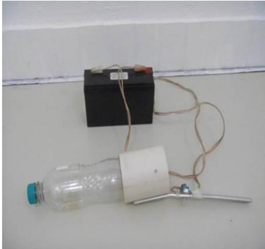
Aspirador elétrico acoplado a uma garrafa PET e a uma bateria para coleta de espécimes de flebotomíneos.
