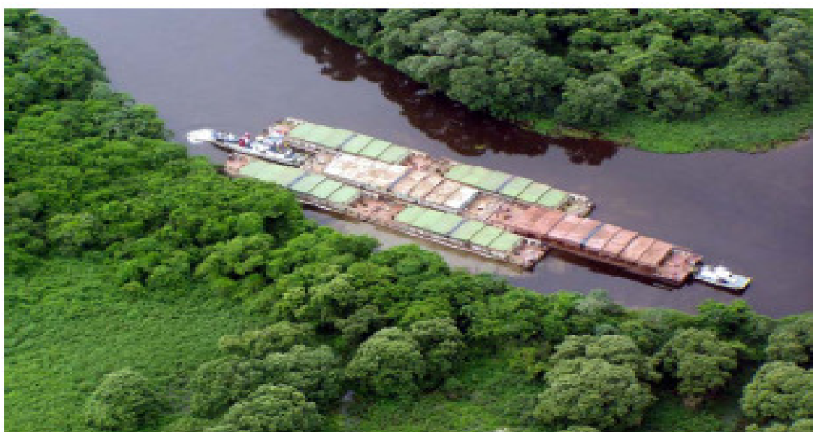
Figura 41: Comboio 2x3 de barcaças com empurrador de proa.
