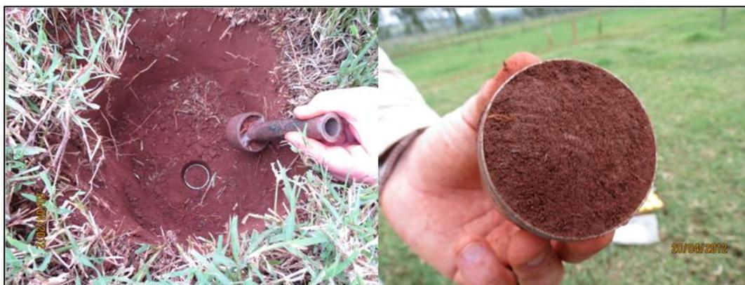
Figura 7. Ilustrações da coleta dos anéis indeformados na área experimental em 20 de abril de 2012, Mariluz-PR.
