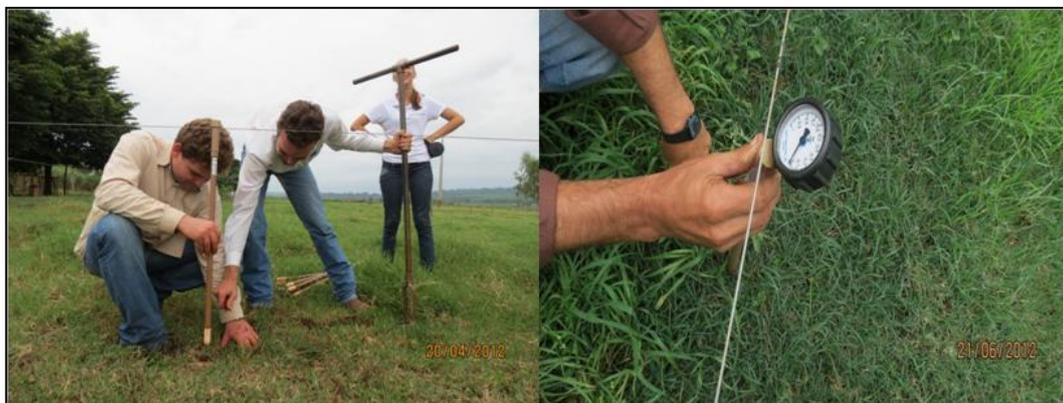
Figura 6. Ilustrações da instalação e monitoramento dos tensiômetros na área experimental em Mariluz-PR, 2012.
