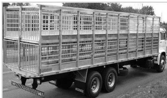
a) Carroceria metálica, dois andares Fonte: Posmovil (2013)
