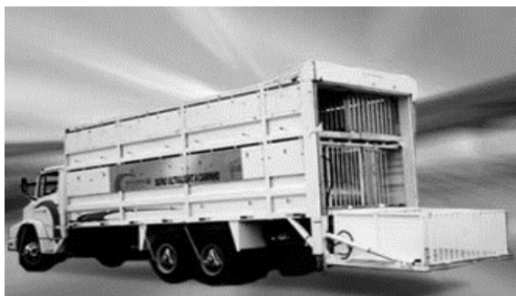
c) Carroceria metálica, equipamento de elevação Fonte: RMS Equipamentos hidráulicos (2013) FIGURA 2. Tipos de carroceiras para transporte de suínos
