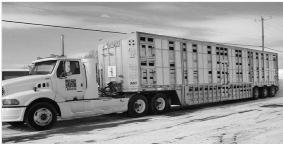
FIGURA 3. Caminhão comum ( pot-belly ) para transporte de suínos no Canadá.
