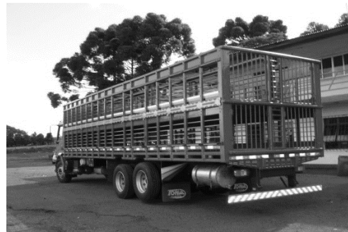
b) Carroceria de madeira, dois andares Fonte: Tonial carrocerias (2013)
