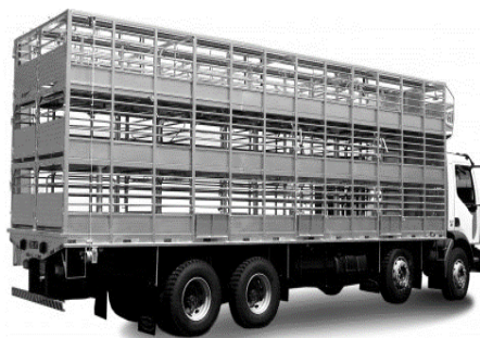
d) Carroceria metálica, três andares Fonte: Triel-HT (2013)
