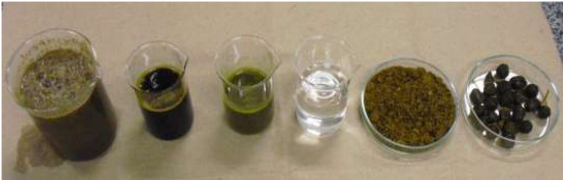
2 - Componentes do substrato (glicerina bruta, inóculo, água e dejetos de ovinos).
