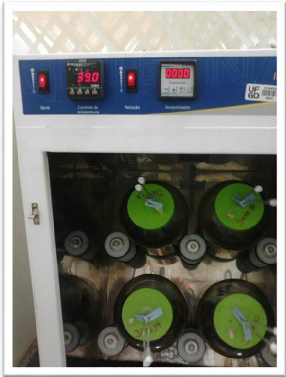
Anexo 1 – Figuras da adaptação dos jarros para coleta de líquido oriundo da digestibilidade in vitro, para determinação do pH e N- amoniacal.
