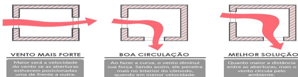
Figura 5 - Exemplos de ventilação cruzada
